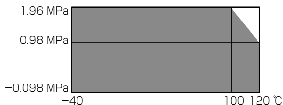
図3. ETFEライニングの流体圧力と温度の関係
