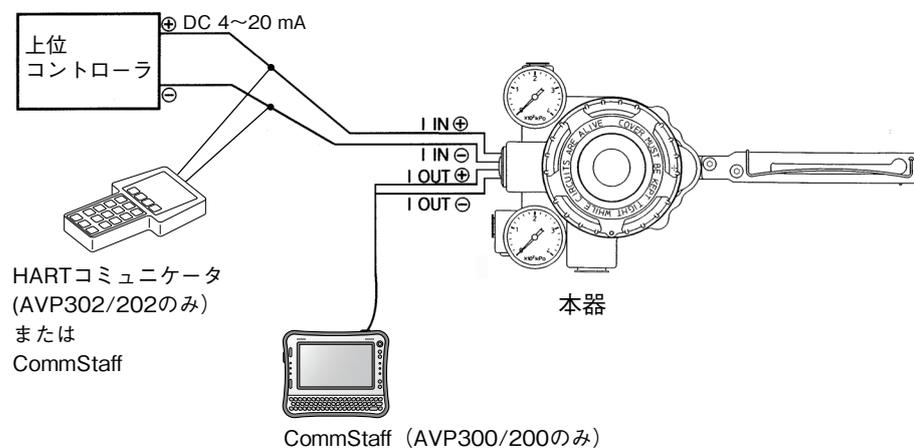
図 1-2 出力なしのシステム構成（AVP300 / 302 / 200 / 202）
