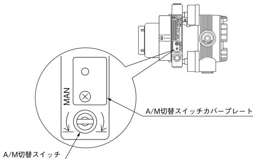
図 5-1 A/M 切替スイッチの構造
