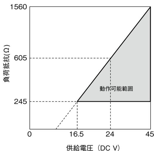
図 2-16 供給電源電圧／負荷抵抗特性
