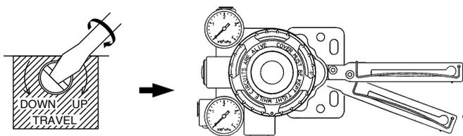
図 3-2-2 レバー下降方向への調整
