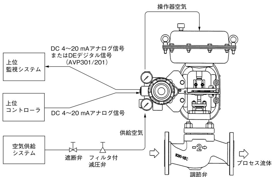
図 1-1 制御システム概念図
