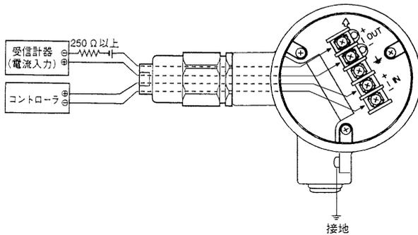
図 2-15-1 開度発信を使用する場合（4線ケーブル）の電気配線
