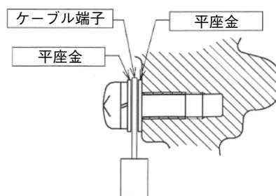
図 2-13 外部接地端子への接続
