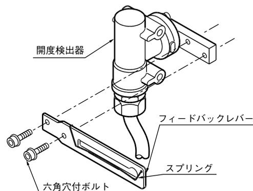
図 フィードバックレバーの組み付け
