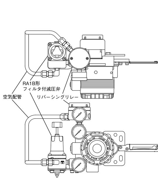
図 2-10-1 RA1B 組み付けのときの
