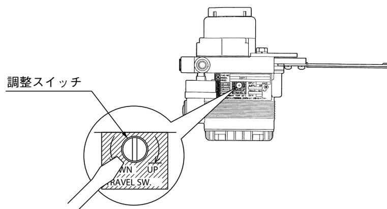
図 3-1 外部ゼロ・スパン調整部の構造
