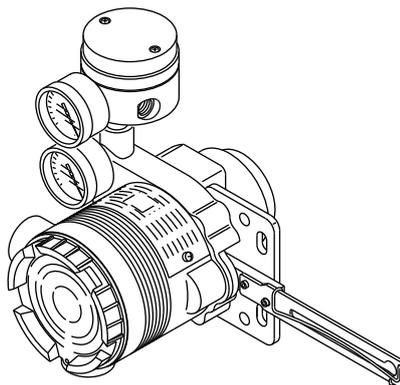
図 2-8 リバーシングリレーのねじ込み
