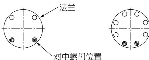
图 2-13 检测器的水平对中
