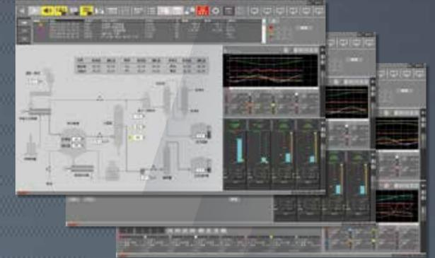
運転、監視に必要な情報のセットを組み合わせで登録し、いつでも決まったセットで簡単に運転画面が呼び出し可能です。オペレーションの熟練度による画面展開の違いを解消し、運転視線を標準化します。
