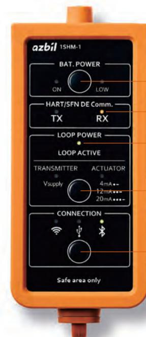
ボタンを押すと、ホストPCと無線接続をしている場合に、内蔵電池から本体への電源供給を行います。左右のLEDで内蔵電池使用状況や電圧低下の警告を表示します。
