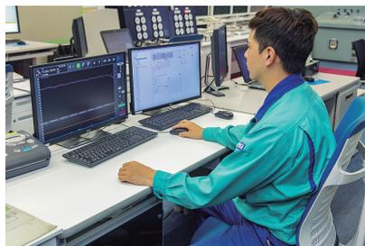
集中監視室に設置されたBiG EYESの端末。各監視ポイントの状態を確認するトレンド監視ビューアー(左)では、計測値がいつもと違う動きをした際には直感的に状況を判断することができる。設備の監視対象となる計測点を設定し、モデル作成を行うコンフィギュレーター画面(右)。
