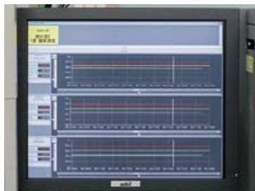
ACTMoS の監視画面。縦の白いラインが「現在」を表し、それよりも左側に登録されたポイントの「過去」のアナログ計測値、白いラインより右側が「将来」を予測した値となる。
