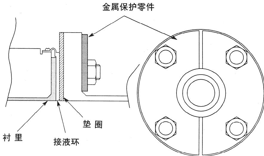
图 2-15 接液环是 SUS 材质的場合 (使用金属保护零件)
