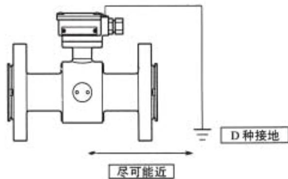
图 2-33 由外部接地端子接地
