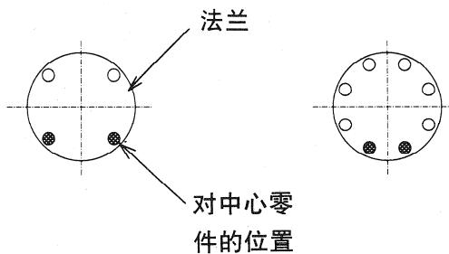
图 2-9 水平安装的场合 (左右法兰上各安装 2 个)
