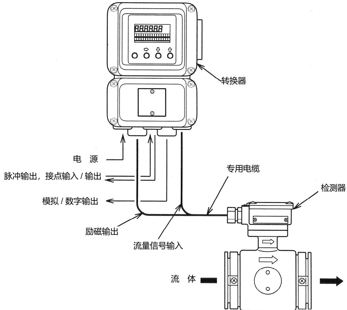
图 1-2 分离型的测定系统概念图
