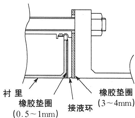
图 2-16 接液环是 SUS 材质的場合 (使用橡胶垫圈)
