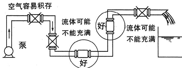
图 2-1 安装实例
