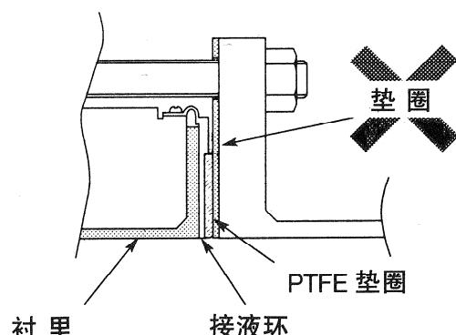
图 2-13 错误的安装方法
