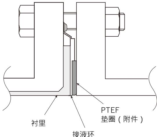
图 2-29 在 2.5A-200A 的条件下，接液环为 SUS 以外的材质的场合
