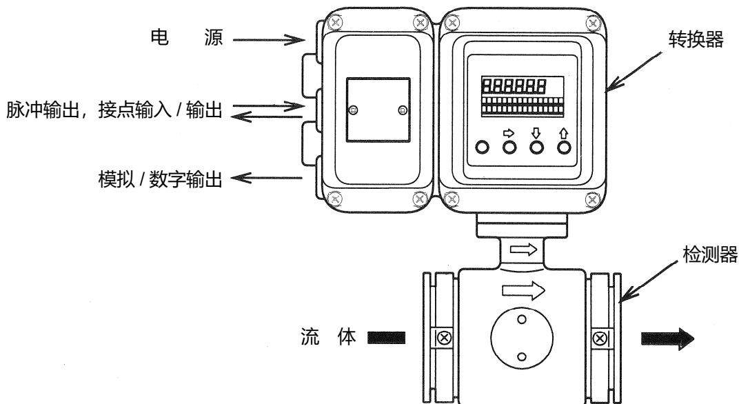
图 1-1 一体型的测定系统概念图
