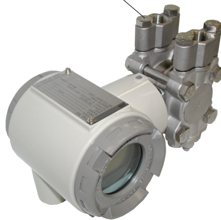
図2-13 プロセス接続口の上下位置変更
